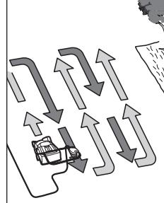
Coloque el producto en el borde de césped situado más próximo a la toma de corriente. Trabaje apartándose lateralmente de la toma de corriente en cada franja.
