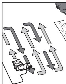
Встановіть виріб з краю газону якомога ближче до розетки. Працуйте в напрямку від розетки. Після кожного розвороту перекладайте шнур на протилежний, вже оброблений бік. Під час аерації/культивації **не перевантажуйте мотор.**
