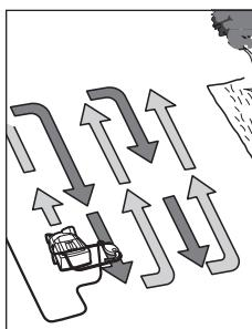
Umístěte výrobek na okraj trávníku a co nejblíže k síťové zásuvce. Pracujte směrem od síťové zásuvky. Kabel dejte po každé obrátku na protilehlou, již obdělanou stranu.
