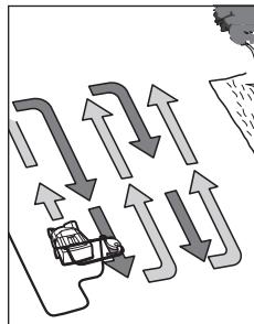
Postavite proizvod na ivicu travnjaka i što je moguće bliže mrežnoj utičnici. Radite dalje od mrežne utičnice. Nakon svakog obrtanja postavite kabl na suprotnu, prethodno obrađenu stranu. Kod provetravanja/vertikulacije travnjaka **ne preopterećujte motor**.
