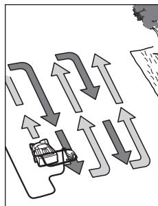
Platzieren Sie das Produkt an der Rasenkante und so nahe wie möglich an der Netzsteckdose. Arbeiten Sie von der Netzsteckdose weg.
